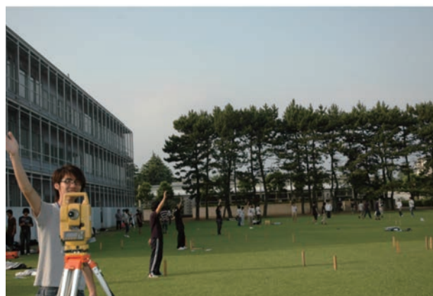
図2 TSによる基本型クロソイドの打設
