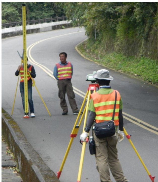
図2. 台湾での精密水準測量の様子。電子レベルを操作しているのは筆者（村瀬）。中央研究院地球科学研究所および国立台湾大学の技官に協力いただき実施している。
