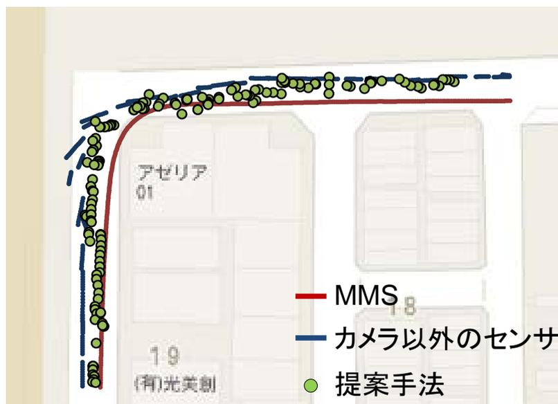
モバイルマッピングシステムと提案手法による平面位置の比較
