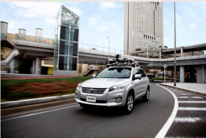
▲高精度計測車両
