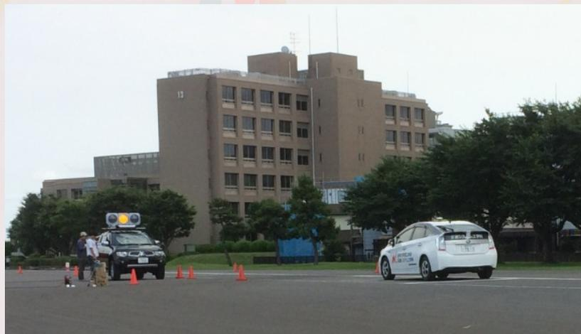
写真 GNSS受信機による車両の走行軌跡計測実験
