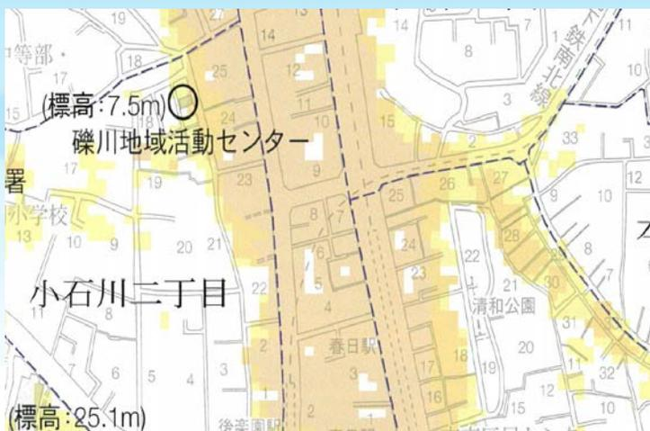
折図の一部をスキャナーで読み取った図（任意に拡大表示）で、現地では平坦に見える土地ですが、「東京都作成の浸水予想区域図を基に、河川の氾濫及び下水道の溢水により浸水が想定される」と図の説明にあります（図の濃い色は0.5-1.0mの想定水深）。
