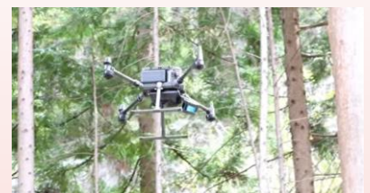
レーザーSLAMを搭載し自動で障害物 を避けて飛行する
