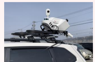
車載型レーザースキャナー（MMS） SLAMレーザースキャナーが搭載され非GNSS 環境下において有効
