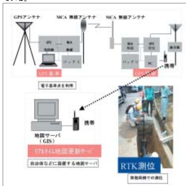
図 - 1 埋設管敷設に関する電子地図リアルタイム更新実験(RTK-GPS利用)
