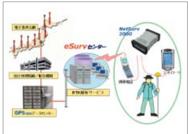
図-1 サーバ型RTK-GPS Net Surv 2000
