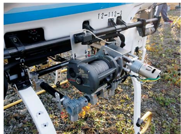
写真－8 吊り下げ・吊り上げのウインチ
