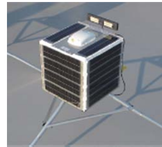
写真-3 GPSモジュール
