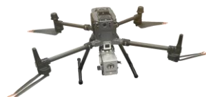
RIEGL社製スキャナ搭載 「Terra Lidar X」
